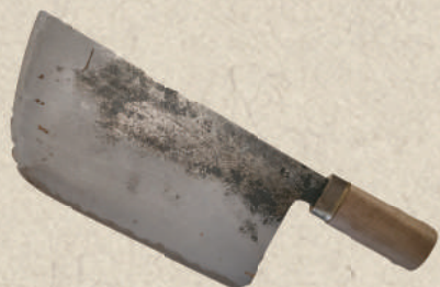
▲榻榻米專用鋼刀，十分鋒利，磨刀是李宗勳每天的重要工作。（鄭佩雯拍攝）
